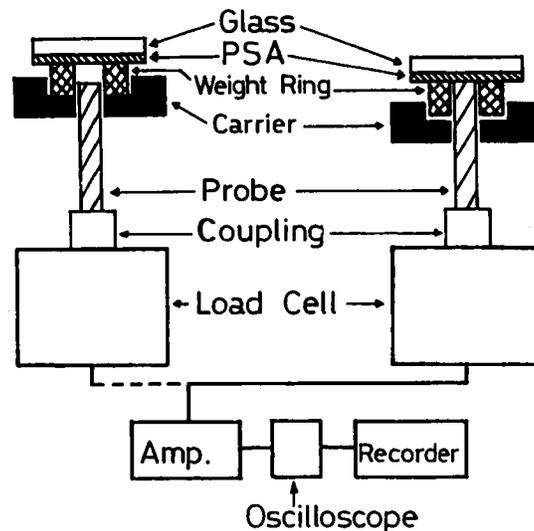
FIGURE 1 NS Probe Tack Tester.
